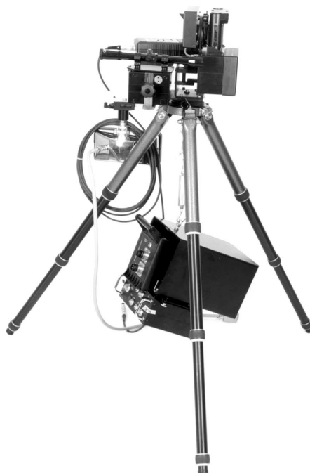
Slika 2. Mjerilo brzine vozila u cestovnome prometu tip SPEEDOPHOT na tronožnom stalku
