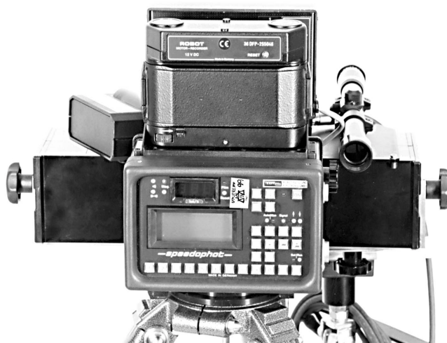
Slika 1. Mjerilo brzine vozila u cestovnome prometu tip SPEEDOPHOT - prikaz stražnje strane mjerila
